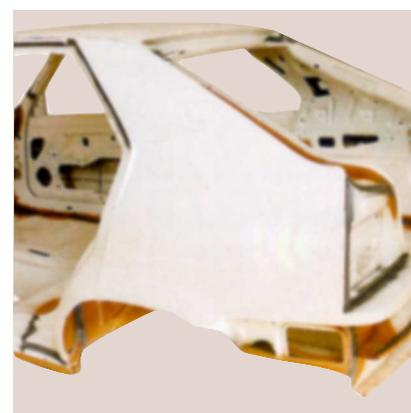
Окрасьте внутренние поверхности панели и подберите цвет на загрунтованной пластине-образце размером 200×200 мм.
