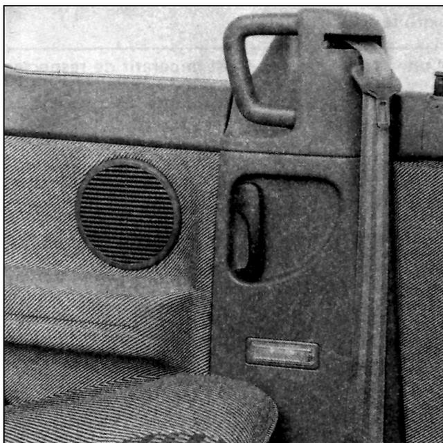
Откройте задние замки и замки крышки отделения для складной крыши, потянув за ручку привода замка, расположенную на средней стойке кузова.
