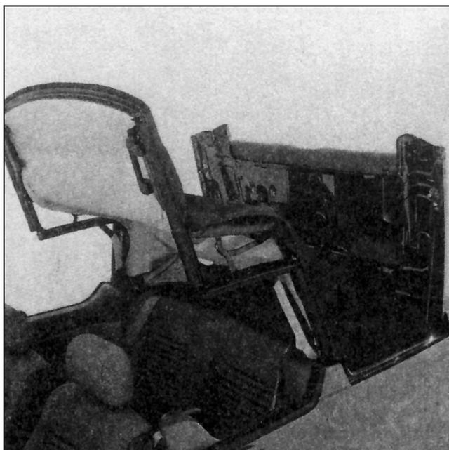
Извлеките складную крышу из отделения и разверните его в направлении к передней части автомобиля.
