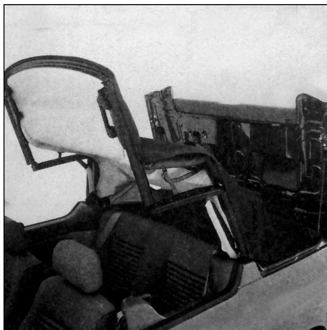
Снимите временный упор и полностью раскройте крышу.
