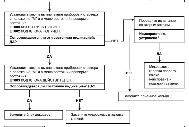
ПОСЛЕ **УСТРАНЕНИЯ НЕИСПРАВНОСТИ**  Выполните полную проверку с помощью диагностического прибора. При замене блока декодера повторите процедуру программирования и настройки конфигурации, см. Техническую ноту, в которой описывается процедура программирования.
