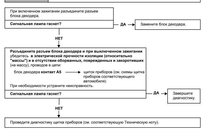
ПОСЛЕ УСТРАНЕНИЯ НЕИСПРАВНОСТИ Выполните полную проверку с помощью диагностического прибора. При замене блока декодера повторите процедуру программирования и настройки конфигурации, см. Техническую ноту, в которой описывается процедура программирования.
