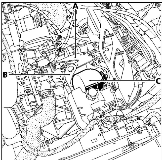
Отсоедините разъемы рассматриваемых электромагнитных клапанов.
