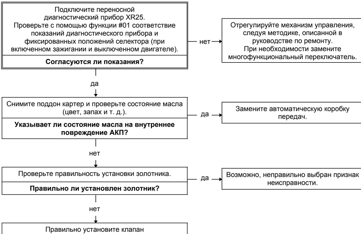
**ALP 7: Автомобиль не трогается с места ни на передней, ни на задней передачах, при повышенных оборотах двигателя**
