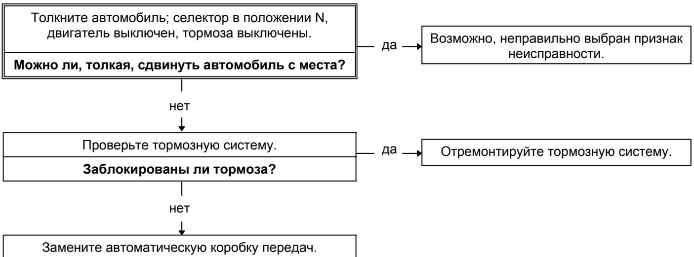
**ALP 9: Запаздывание при переключении передач, сопровождаемое повышением оборотов двигателя с последующим резким рывком с места**
