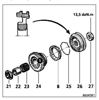
Включите рычагом переключения передач первую передачу и пятую передачу, перемещая вилку включения пятой передачи по штоку.
