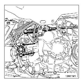
Отверните болт (1) крепления реактивной тяги и ослабьте затяжку болта (2).
