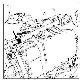
**ПРИМЕЧАНИЕ:** рекомендуется заменять манжету фланца дифференциала при каждом снятии приводного вала (см. соответствующий раздел).
