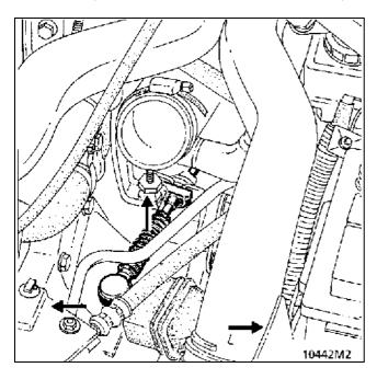
Выньте скобу крепления троса привода переключения передач и снимите наконечник троса с шаровой головки рычага привода переключения передач.
