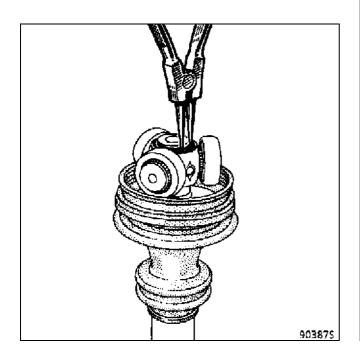
На прессе снимите трехшиповик, используя в качестве упора съемник.
