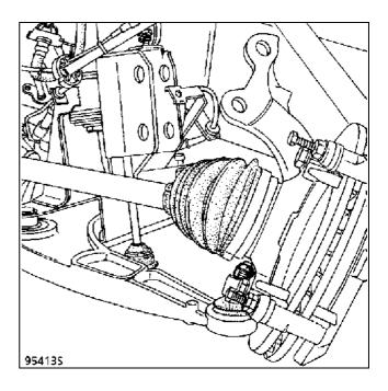
Снимите приводной вал.
