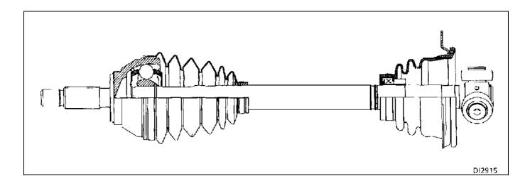
Внутренний шарнир левого приводного вала — коробки передач РК и ЈС
