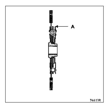
Для установки ведомого диска используйте имеющуюся в комплекте пластмассовую центрирующую оправку.
