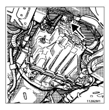
Снимите пружинный держатель и снимите трос выбора передач.
