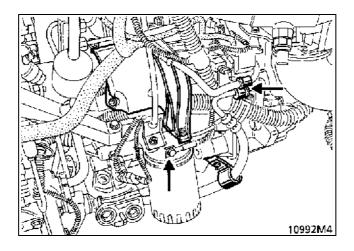
Чтобы облегчить доступ к болтам крепления стартера, снимите датчик частоты вращения и положения коленчатого вала.
