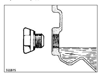
Масло заливается в картер коробки передач, пока оно не начнет вытекать из маслозаливного и контрольного отверстия.
