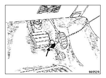
Выключатель замыкается при нажатии педали до упора с преодолением сопротивления в конце ее хода.
