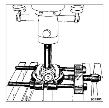
Гофрированный чехол с подшипником внутреннего шарнира левого приводного вала
