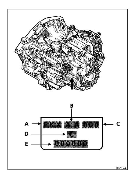
В маркировке на картере коробки передач указываются:
