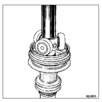
Установите стопорное кольцо или зачеканьте в трех точках через 120°, накатывая металл на шлицы приводного вала.
