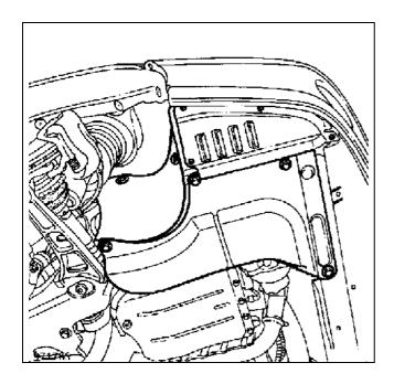
Снимите маслосборник, установленный под коробкой передач, и слейте масло из коробки передач.
