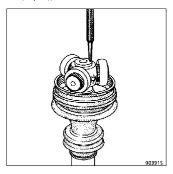
Смажьте корпус шарнира и установите его на трехшиповик.
