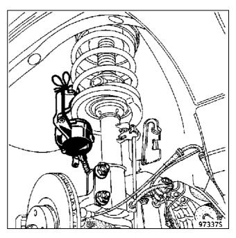
Отсоедините провода датчика скорости колеса АБС (если она есть) от скоб крепления.
