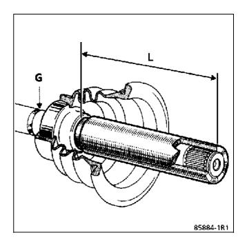
Чтобы избежать повреждения подшипника с уплотнительной манжетой, что может стать причиной утечки масла, для установки подшипника не пользуйтесь молотком, а пользуйтесь прессом, обеспечивающим постепенное нарастание давления.
