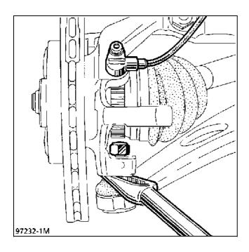
Снимите узел ступицы – поворотного кулака – тормозной диск в сборе с приводным валом.
