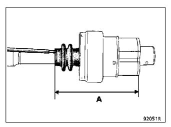
Переместите корпус шарнира по валу так, чтобы получить размер  $A = 156 \pm 1$  мм (размер между концом чехла и участком наибольшего диаметра обработанной поверхности корпуса шарнира).
