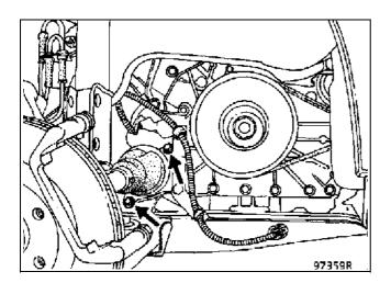
палец шарового шарнира наконечника рулевой тяги, пользуясь съемником Т. Av. 476.
