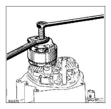
Снимите ведущую шестерню пятой передачи вместе с блокирующим кольцом синхронизатора, игольчатым подшипником, втулкой и шайбой.
