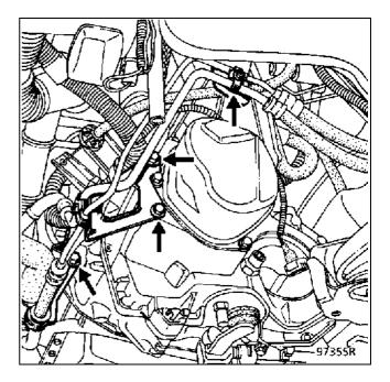
Отверните болт крепления массовой шины коробки передач.
