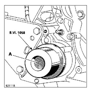
Расположите приводной вал напротив полуосевой вал-шестерни.
