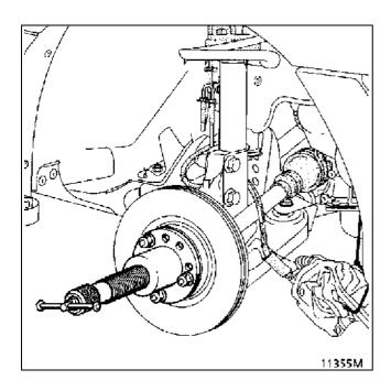
Удалите нижний болт крепления амортизаторной стойки к поворотному кулаку и отведите в сторону поворотный кулак.
