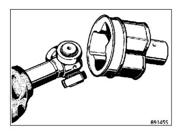
ПРИМЕЧАНИЕ: корпус шарнира не имеет стопорного кольца, благодаря чему он может быть снят без усилий.
