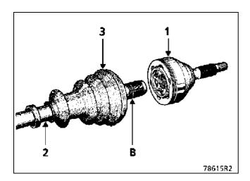
Заполните чехол и корпус наружного шарнира смазкой в равном количестве.
