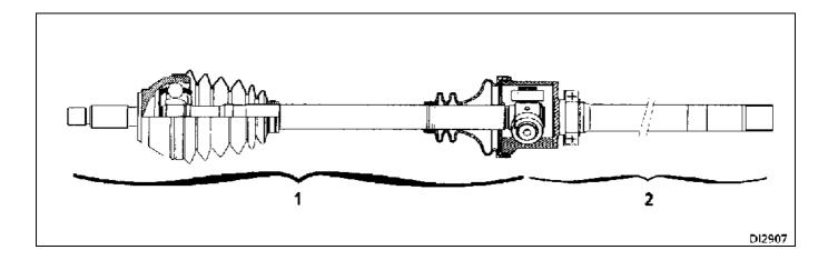
В связи с этим правый приводной вал может быть снят полностью или может быть снята только его наружная часть (внутренняя часть остается на месте, что позволяет не снимать стопорную пластину подшипника и избежать повреждения манжеты фланца дифференциала). Правый приводной вал можно снять и в сборе, если этого требует методика выполнения операций.
