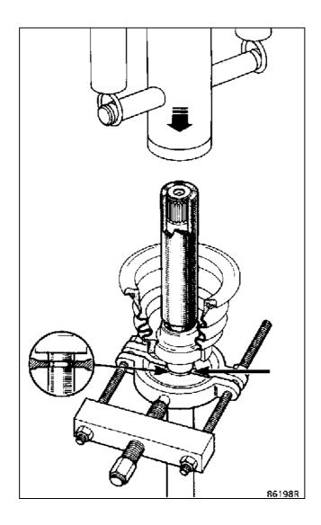
Установите трехшиповик на вал и установите стопорное кольцо (в зависимости от исполнения).
