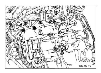
Разгрузите подвеску двигателя, установив опорную стойку с резиновой подушкой под масляный поддон.
