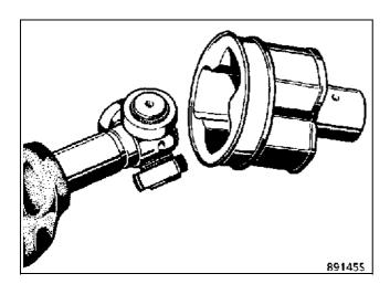
**ПРИМЕЧАНИЕ**: корпус шарнира не оснащен стопорным кольцом, благодаря чему он может быть снят без усилий.
