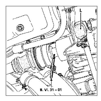
Наклоните поворотный кулак и снимите приводной вал со шлицов полуосевой вал-шестерни (будьте внимательны, чтобы не повредить гофрированные чехлы вала при проведении этой операции) (см. раздел 29).
