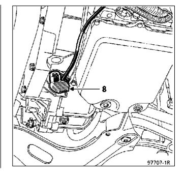
Датчик подсоединен к электропроводке разъемом. Поэтому его можно заменить не разрезая жгута электропроводки.
