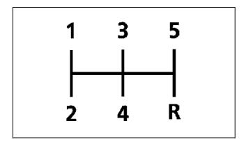
Чтобы включить передачу заднего хода, установите рычаг в нейтральное положение, а затем включите передачу заднего хода так же, как передачу переднего хода.
