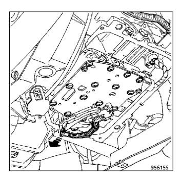
Отсоедините от герметичного разъема жгут проводов, соединяющих многофункциональный переключатель с гидравлическим распределителем, нажав на стопорное кольцо.
