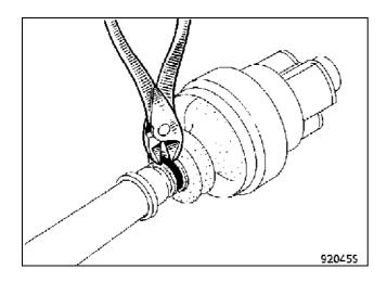
Распилите хомут большого размера, стараясь не повредить канавку на корпусе шарнира.
