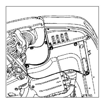
Снимите с двигателя держатели трубопроводов гидроусилителя рулевого управления.
