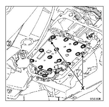
гидравлический распределитель, предварительно отведя селектор до упора и освободив электромагнитный модулирующий клапан в картере.
