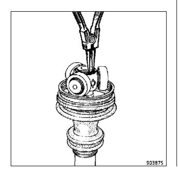
На прессе снимите трехшиповик, используя съемник в качестве упора.
