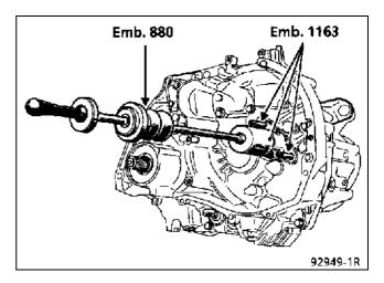
Снимите защитный колпачок и приспособление.
