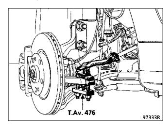
Установите защитный кожух на чехол наружного шарнира приводного вала.
