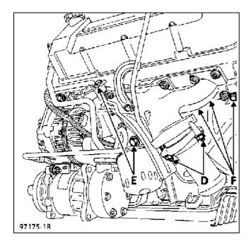
Отверните 3 болта крепления стартера.
