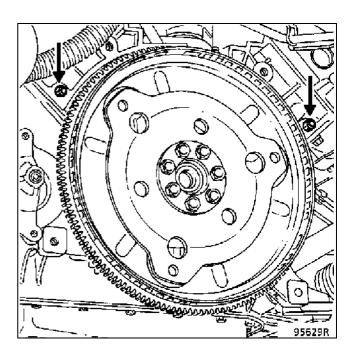
Смажьте смазкой **MOLYKOTE BR2** установочную втулку гидротрансформатора на коленчатом валу.
