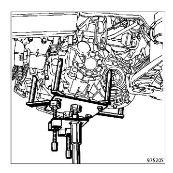
Немного опустите силовой агрегат, чтобы облегчить снятие болтов крепления левой опоры коробки передач (4 болта).
