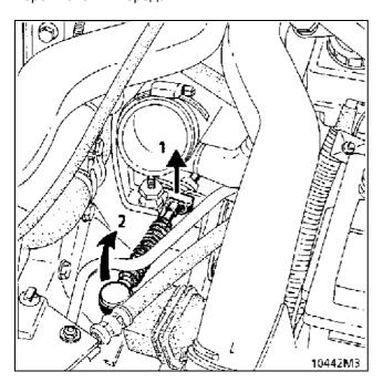
Пропустите трос управления над шлангом системы охлаждения, чтобы исключить его скручивание при отсоединении от коробки передач.
