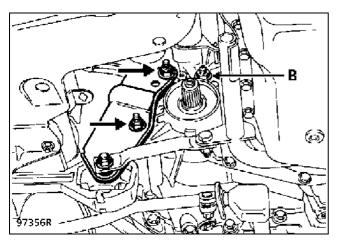
Отсоедините коробку передач от двигателя и опустите ее с помощью домкрата, при необходимости перемещая опору двигателя.
