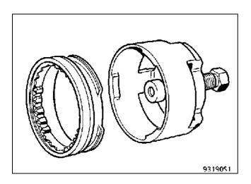
Установите съемником **B. Vi. 1170** скользящую муфту синхронизатора в положение включения пятой передачи и поверните съемник так, чтобы шлицы скользящей муфты синхронизатора и ступицы были расположены друг напротив друга.
