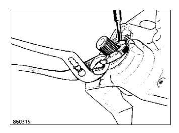
Манжета устанавливается с помощью оправки В. Vi. 1058 и защитного колпака (A) оправки В. Vi. 945.
