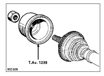
**ПРИМЕЧАНИЕ:** В запасные части поставляются приводные валы зубчатого диска АБС. Поэтому необходимо сохранить старый зубчатый диск АБС для установки его на новый приводной вал. Зубчатый диск АБС может быть поставлен также отдельно.
