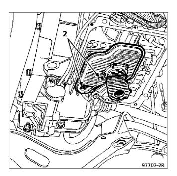
Установите поддон картера АКП (обратите внимание на состояние уплотнительных прокладок и наличие магнитного улавливателя).
