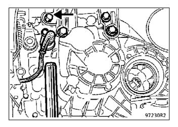
Смажьте торцевую поверхность подшипника промежуточной опоры правого приводного вала, чтобы предупредить прикипание деталей до следующего снятия.
