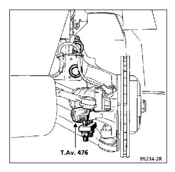
Выпрессуйте из поворотного кулака палец шаровой опоры рычага подвески и палец шарового шарнира наконечника рулевой тяги. Снимите узел ступицы – поворотного кулака – тормозного диска вместе с приводным валом.
