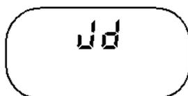
Если отображается буква "**J**", это указывает на неисправность датчика уровня топлива (он был отсоединен более чем на **100 секунд**).
