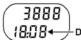
Установка часов производится поворотом кнопки (A) на одну восьмую оборота, чтобы выбрать цифру, которую следует изменить, и путем нажатия на эту же кнопку для подтверждения выбора.
